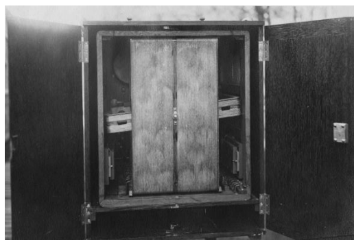
Afb. 14-62 Achterkant ontvanger type T.S.F.B. voor persberichten.
