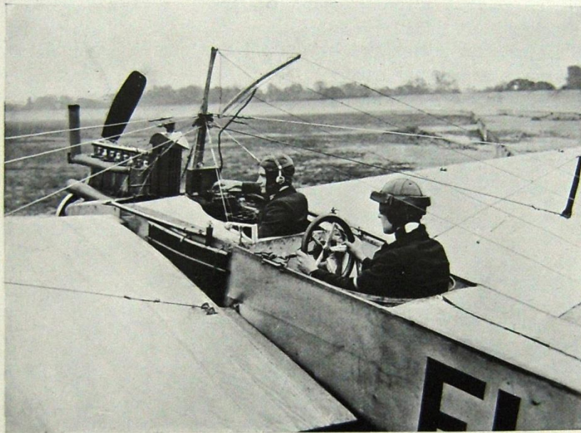
Poste de Télégraphie sans fil à bord d'un Aéroplane Flanders. Radiotélégraphiste : Mr. C. V. Waynffete-Matheu ; Pilote : Feu Mr. Fischer
