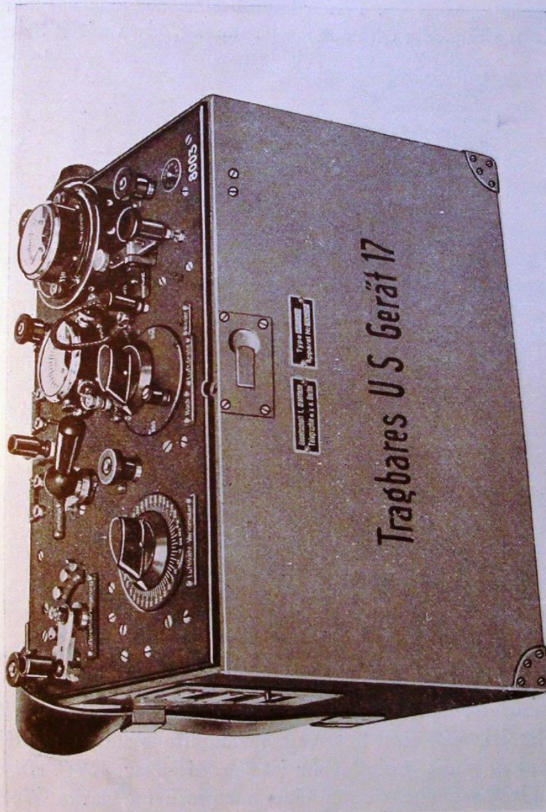
Fig. 586. Einfacher direkter Röhrensender (Telefunken) von 10 Watt für Gleichstromspeisung etwa \frac{1}{8} nat. Größe).
