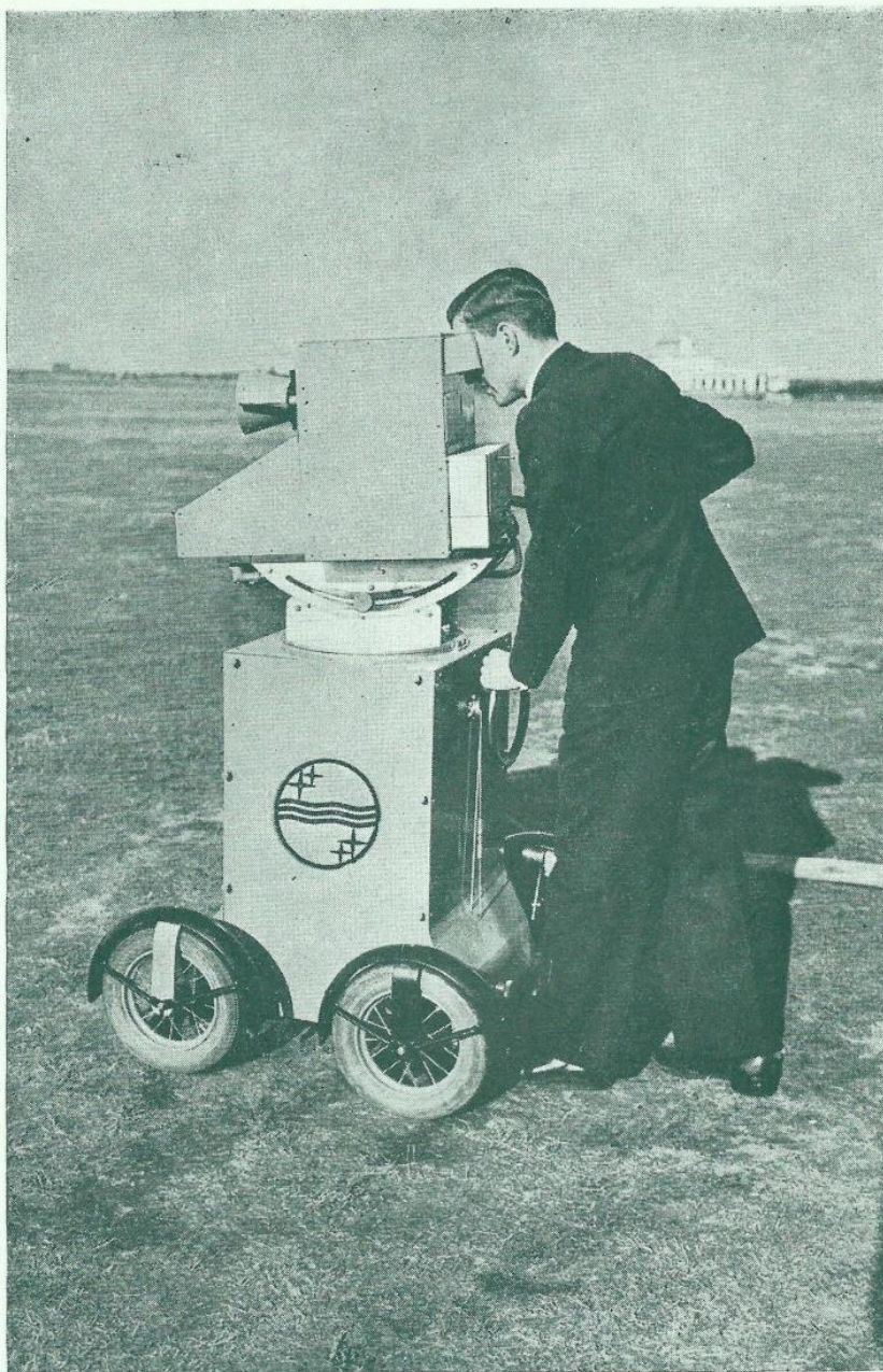
Het opname-apparaat, dat den iconoscoop bevat.
