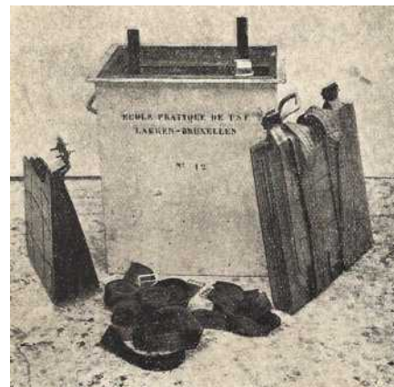
Afb. 138 Een batterij condensators voor hoge spanning, ontworpen en gefabriceerd te Laken (zie opschrift). (Victor Boin, l'école pratique de Laeken, 1913)
